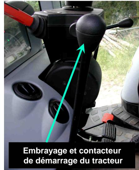
Embrayage et contacteur de démarrage du tracteur
