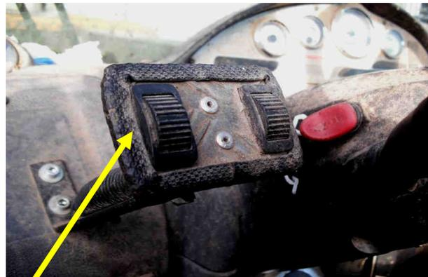
► Molettes de commande d'un chargeur JCB déplacées côté gauche.
