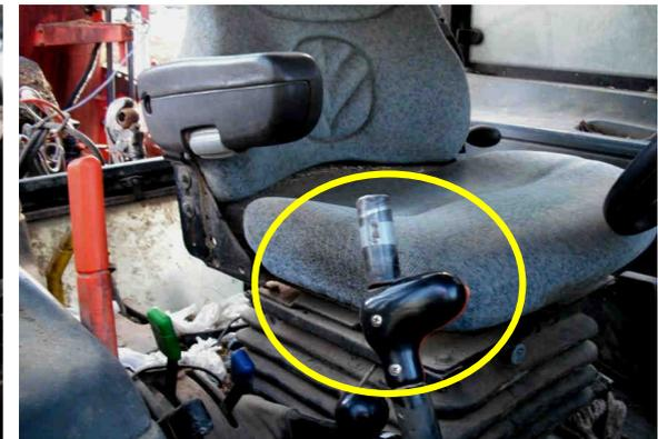
► Pommeaux de commande d'un tracteur JCB modifiés afin d'avoir de la préhension avec la prothèse myo-électrique.
