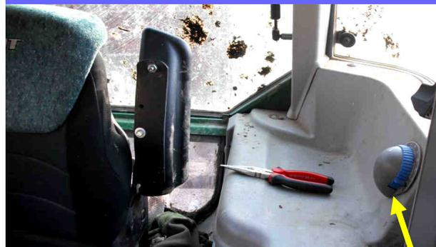
► Molettes de commande du relevage d'un tracteur déplacées côté gauche.
