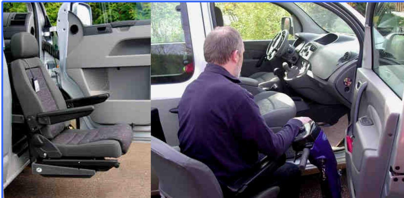
Mise en place d'un siège pivotant électrique côté passager.
