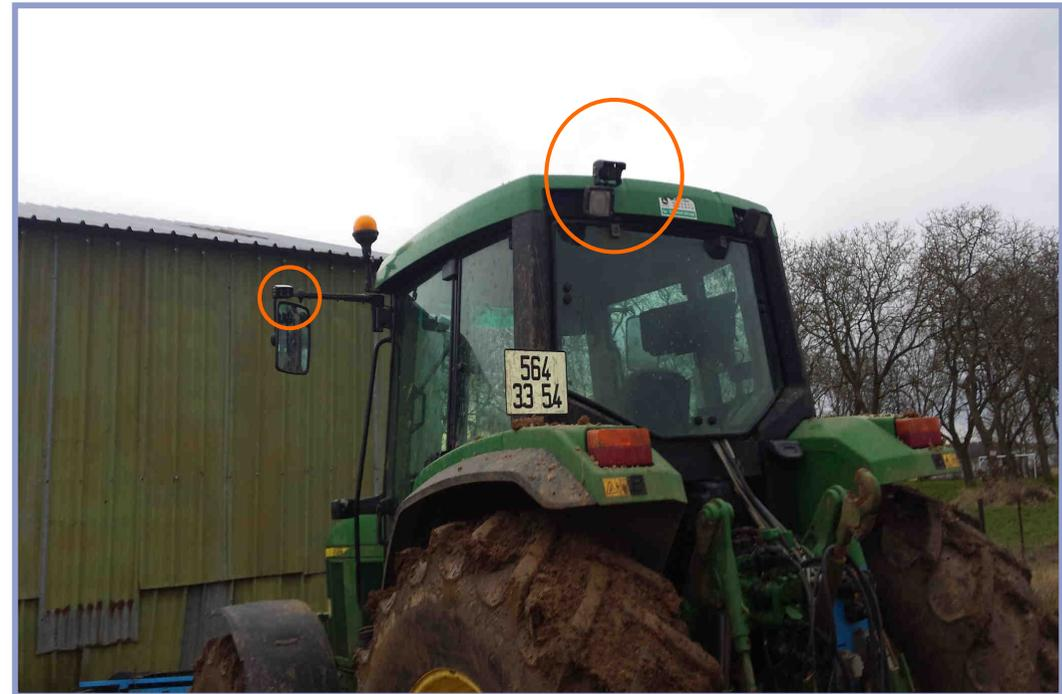
Mise en place de **2 caméras** reliées à un écran à l'intérieur de l'habitacles des engins de l'exploitation.
