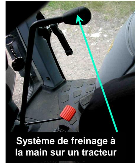
Système de freinage à la main sur un tracteur
